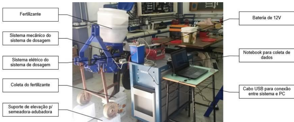
FIGURA 5. Estrutura montada para a realização dos testes.
