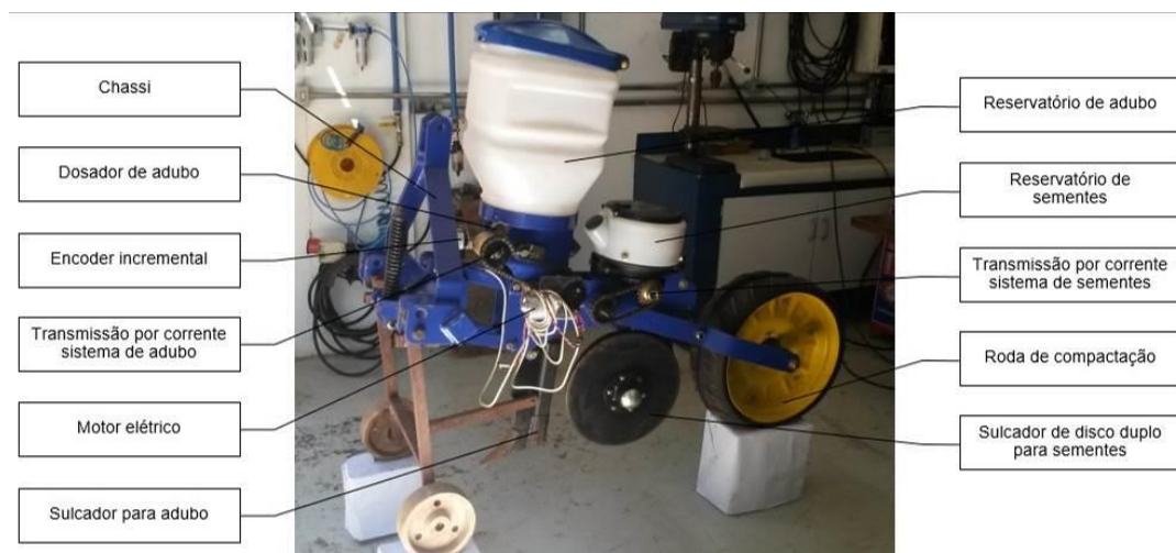
FIGURA 2. Foto com descrições da semeadora-adubador, onde o sistema foi montado.
