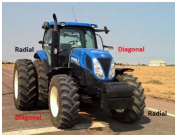
Figura 1. Disposição dos diferentes tipos construtivos de pneus no trator em forma X.
