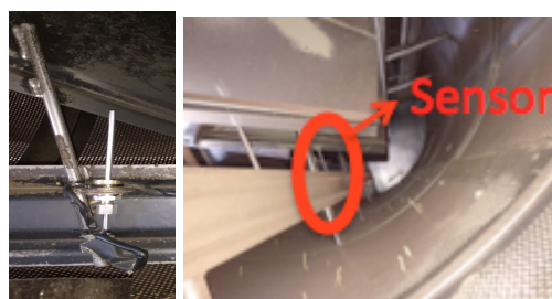
FIGURA 4. Sensor PT100 no interior do cilindro e localização na chapa de revolvimento.
