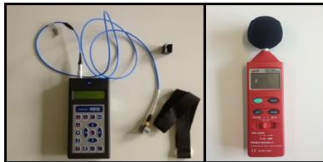
FIGURA 1. Sistema de aquisição HVM-100 e medidor de pressão sonora DEC-460.
