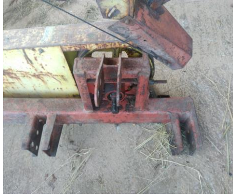
Foto 5. Ponto de acoplamento do eixo de transmissão de potência da colhedora.
