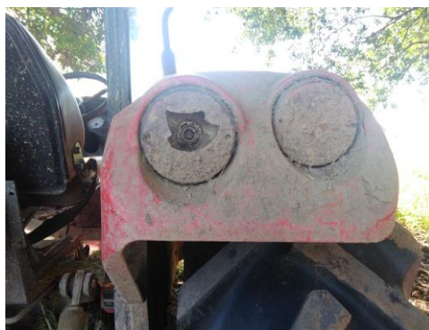
Foto 1. Lanterna traseira danificada.
