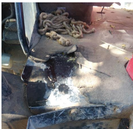
Foto 3. Plataforma de operação com superfície antiderrapante deteriorada.
