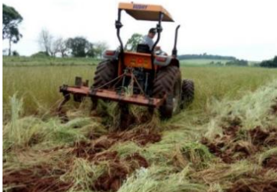
FIGURA 1. Subsolador empregado no solo sob cultivo mínimo
