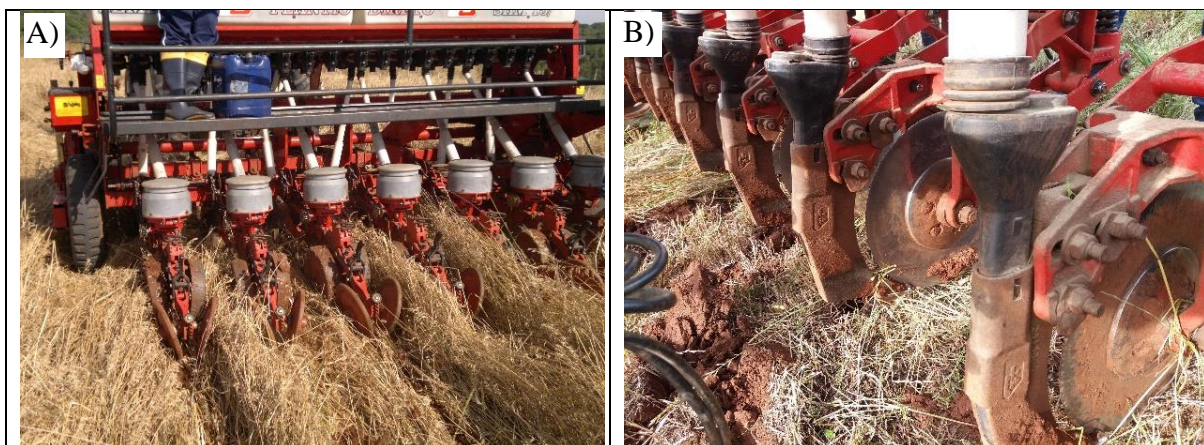
FIGURA 1. A) Semeadora-adubadora utilizada na implantação do experimento, B) Haste sulcadora utilizada na semeadora.
