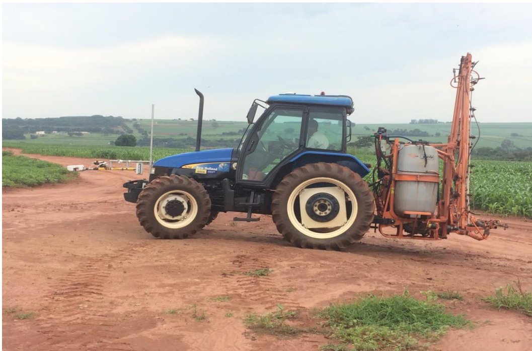
FIGURA 2. Trator equipado com o GreenSeeker no momento do sensoriamento terrestre.
