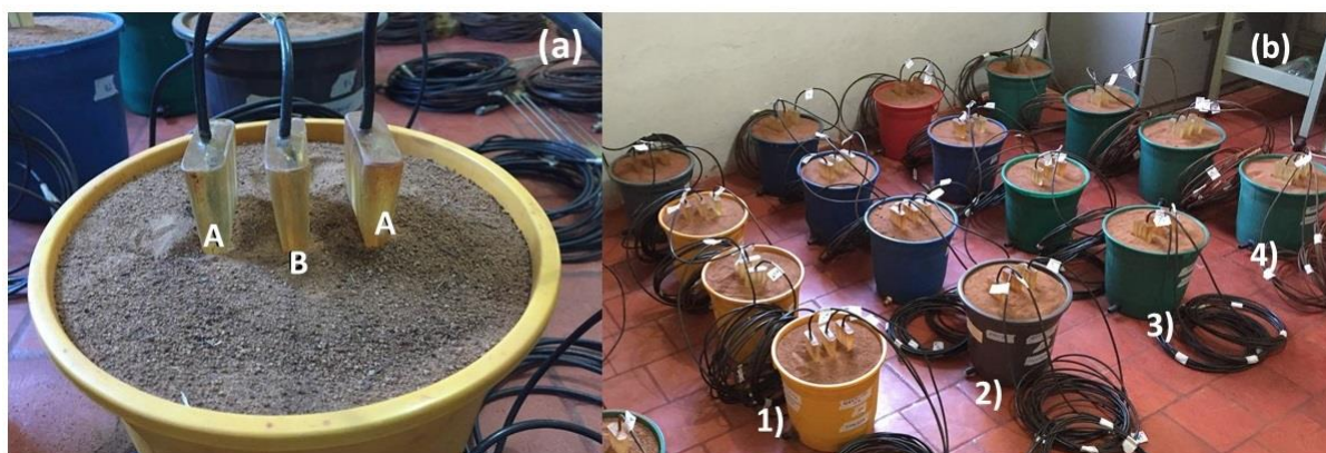
FIGURA 1. (a) Balde com sondas inseridas no solo, onde A e B representam as sondas laterais e central, respectivamente; (b) Apresentação da disposição dos
