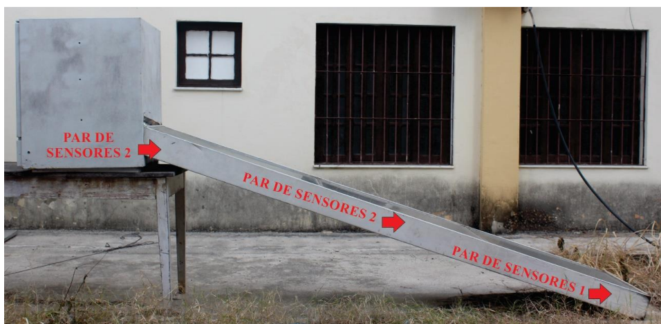
FIGURA 6. Localização dos sensores do Arduino no coletor solar.
