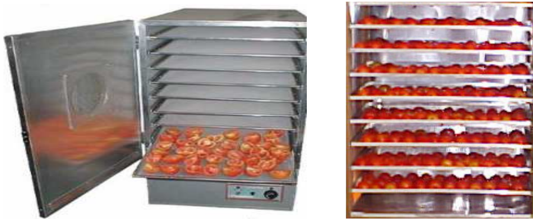
FIGURA 2. Ilustração do sistema de secagem: a) Estufa de secagem a vácuo composta de oito bandejas; b) Secador de bandejas carregado com amostras de tomate.
