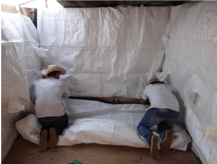
Figura 3 - Disposição do revestimento dentro da carroceria e início da aplicação do revestimento da carroceria.
