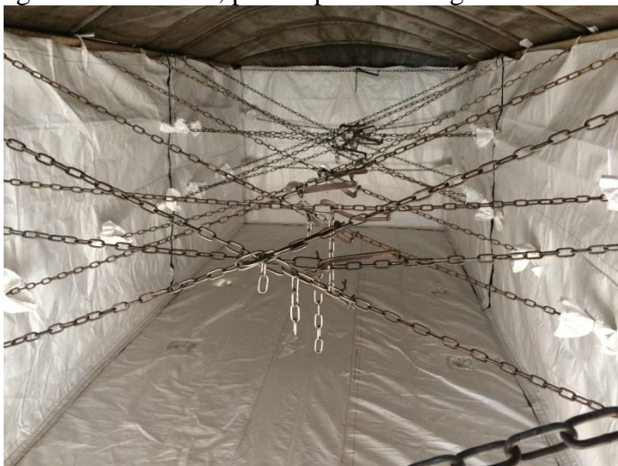
Figura 7 - Revestimento instalado na carroceria.
