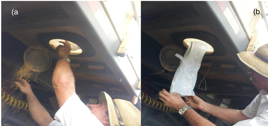
Figura 8 - Em (a) puxando a válvula do assoalho e em (b) puxando a válvula do revestimento e prendendo-a com velcro.
