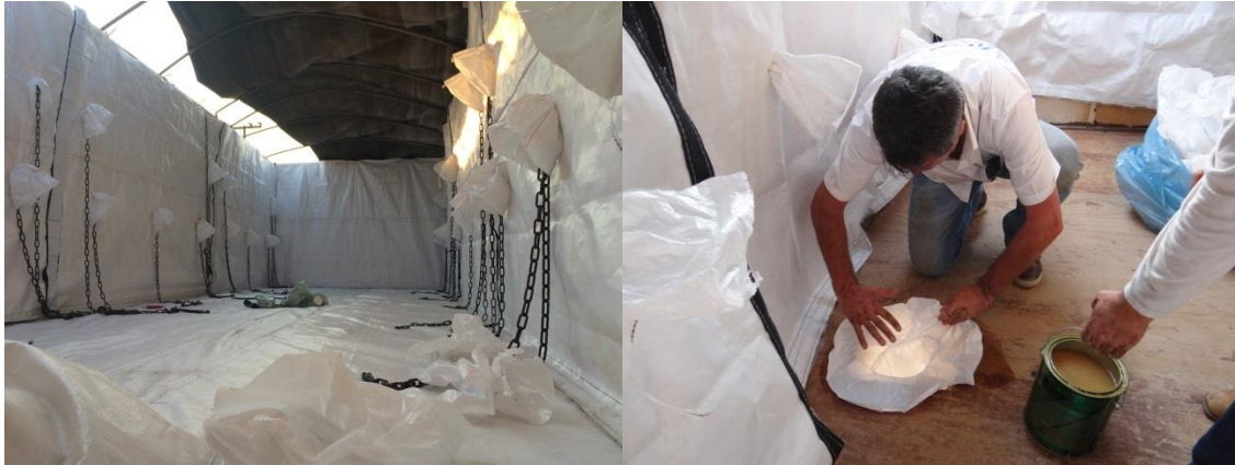
Figura 5 - Válvula nas correntes e fixação da válvula de assoalho.
