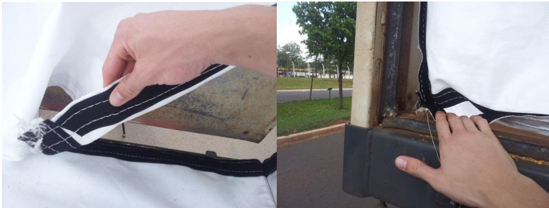
Figura 6 - velcro da tampa traseira do revestimento que possibilita o escoamento da carga.
