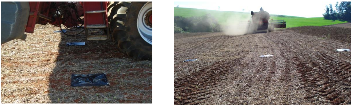
FIGURA 3. Disposição e forma de amostragem de perdas de grãos de feijão na plataforma
