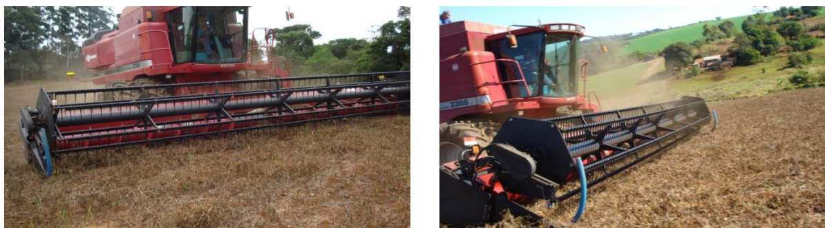
FIGURA 1. Imagem da esquerda mostra o molinete com os dedos padrão de fábrica e, a da direita mostra o molinete adaptado.
