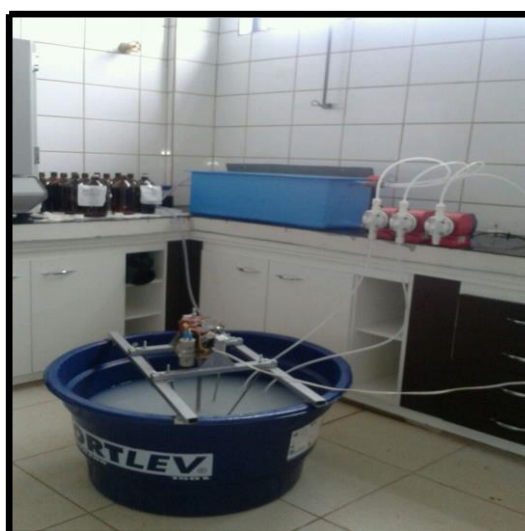
Figura 2. Sistema de tratamento proposto pelo trabalho. Caixa de gordura conectada à caixa d'água de alimentação através de bombas reguladoras de vazão.
