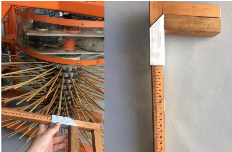
FIGURA 1. Instrumento para medição das oscilações das hastes osciladoras. Os valores aferidos foram tabulados e validados pelo teste de F, e quando significativos a nível de 5% de erro, foram submetidos ao teste de Tukey.
