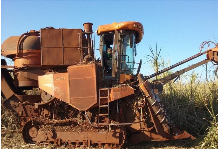
FIGURA 2. Colhedora de cana-de-açúcar VALTRA BE1035e
