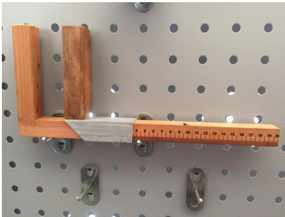
FIGURA 1. Instrumento para medição das oscilações das hastes osciladoras.
