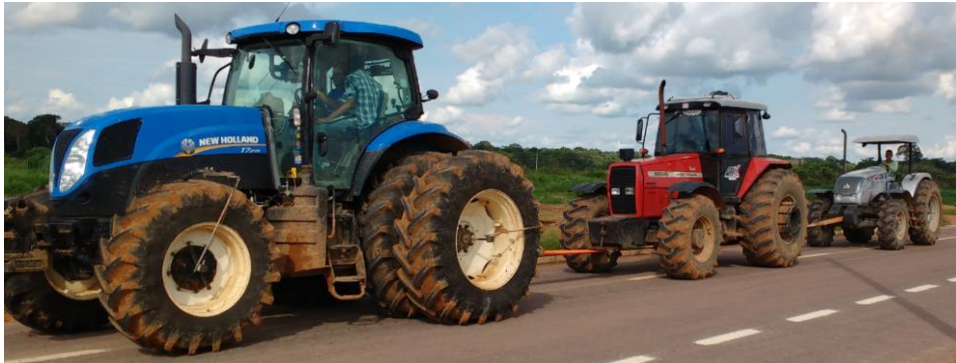
FIGURA 2. Esquema de comboio para ensaios de tração em pista de asfalto, permitindo a validação do suporte da célula de carga.
