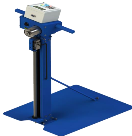
Figura 1. Penetrômetro utilizado para medir a resistência do solo à penetração Fonte: DLG, 2017.
