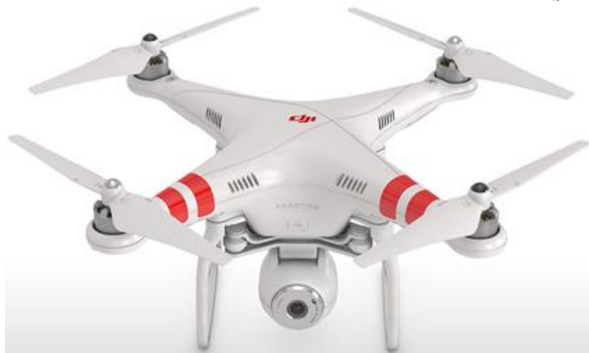
FIGURA 1. RPA (Modelo DJI Phantom 2 Vision), utilizado nas coleta de imagens do experimento relação a coleta de imagens RGB na cultura do trigo (Seara/SC - Safra 2015).
