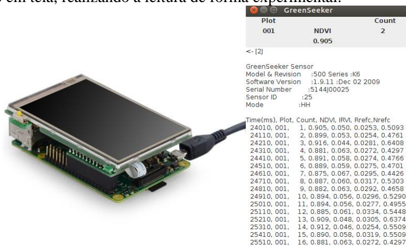
FIGURA 2. Raspberry PI com a tela montada e screenshot da aplicação que foi desenvolvida, realizando a leitura dos dados.
