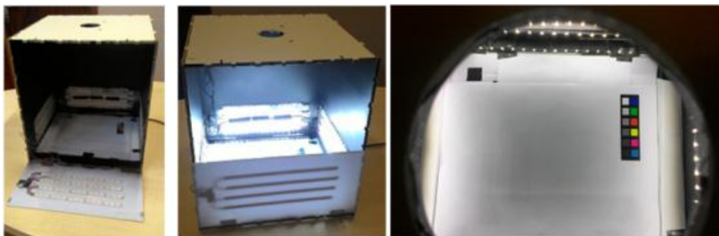
FIGURA 1. Caixa utilizada para padronizar a coleta de imagens.
