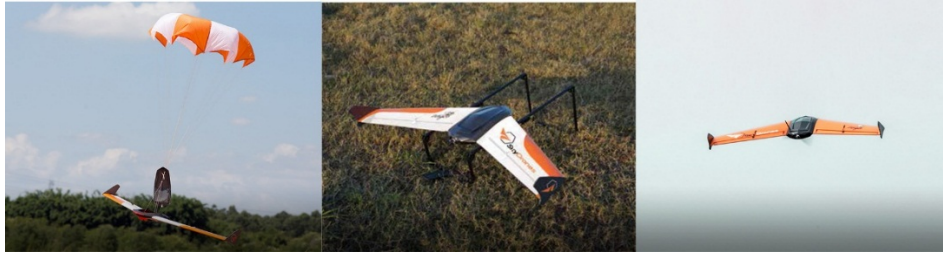
Figura 2. Veículo aéreo não tripulado (VANT), modelo Zangão V em operação.
