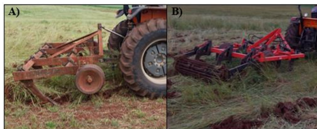
FIGURA 1 – A) Subsolador 1 convencional; B) Subsolador 2 dotado de disco e rolo
