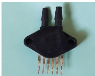
Figura 3. Sensor utilizado para aferir pressão no micro tubo.
