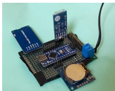
Figura 2. Datalogger desenvolvido para aquisição e armazenamento de dados.
