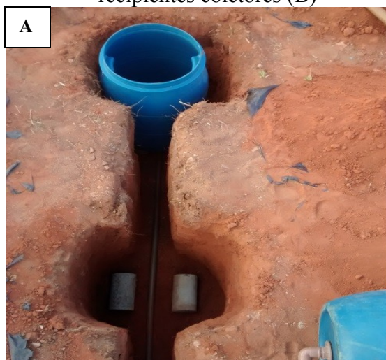
Figura 2. Instalação dos lisímetros de drenagem: colocação dos lisímetros (A), trincheira para recipientes coletores (B)
