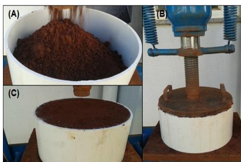
Figura 1 - Disposição do solo no anel para receber a compactação (A); processo de compactação com auxílio da Prensa hidráulica Bovenau (B); anel com solo compactado (C).
