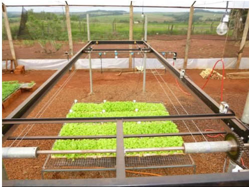
FIGURA 02 Linha lateral autopropelida e sistema de irrigação com aspersões fixos.
