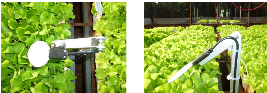
FIGURA 01 Sensor de molhamento foliar instalado acima da cultura e com ângulo de 45°
