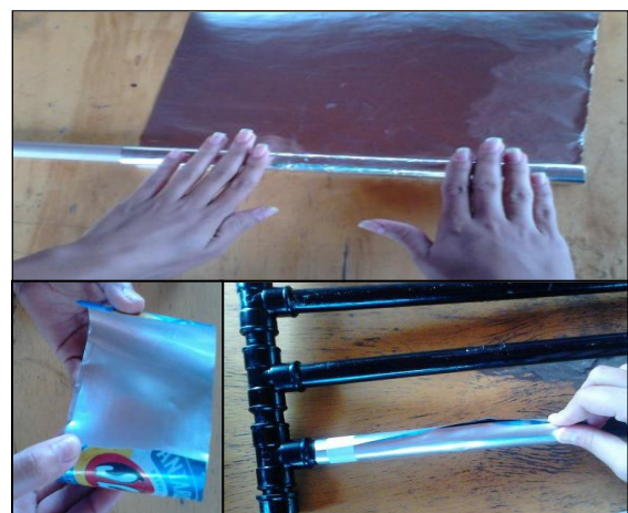
FIGURA 2. Revestimento dos canos com papel alumínio e latinha de alumínio
