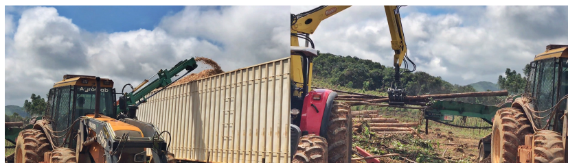
FIGURA 2. Funcionamento da planta móvel de produção de cavaco integral
