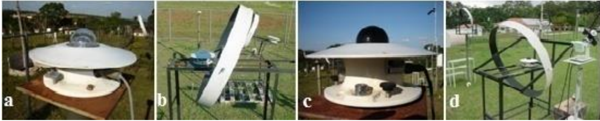
Figura 1: a) Piranômetro medindo a global total; b) piranômetro com anel de sombreamento medindo a difusa total; c) piranômetro medindo a global NIR, e d) piranômetro com anel de sombreamento medindo a difusa NIR
