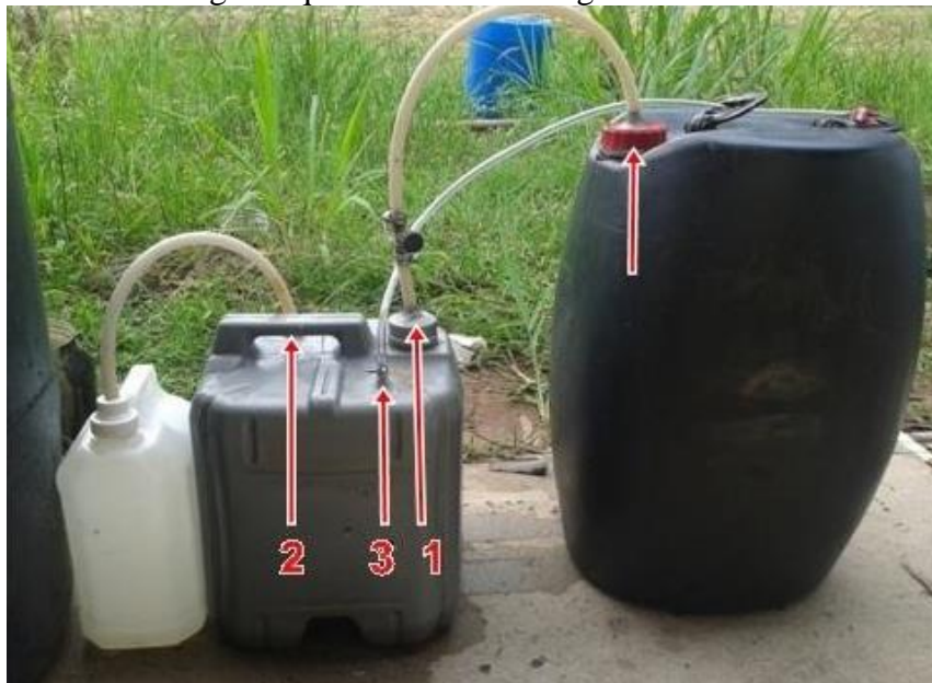
FIGURA 1. Modelo do Biodigestor e do galão quantificador de biogás utilizado.
