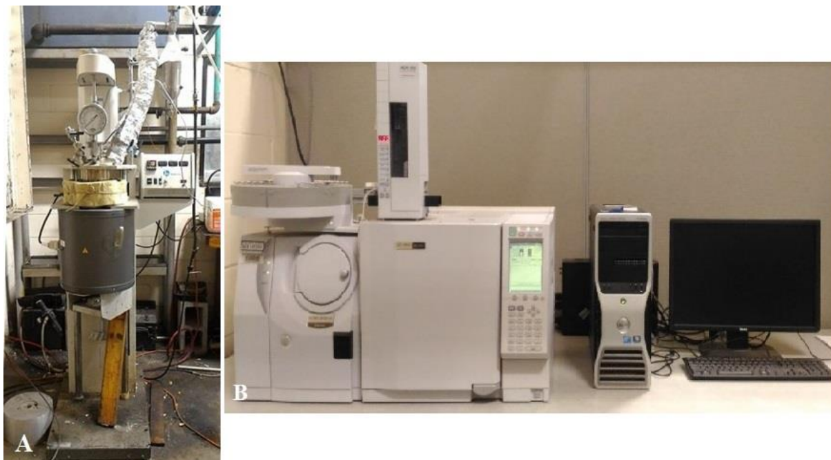
FIGURA 1. A) Reator em batelada (Série 4570 HP/HT, Parr ® Instrument Company). B) Da esquerda para a direita: AOC-20s auto samples, AOC-20i auto injetor e GC-MS QP2010 (Shimadzu ® Inc.), desktop para o armazenamento de dados e controle de parâmetros.
