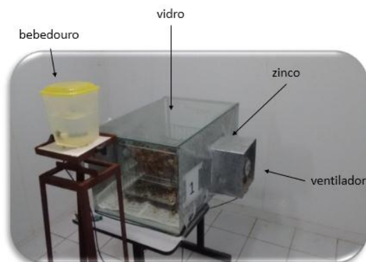
Figura 1. Esquema de instalação da minicâmara no interior da câmara climática
