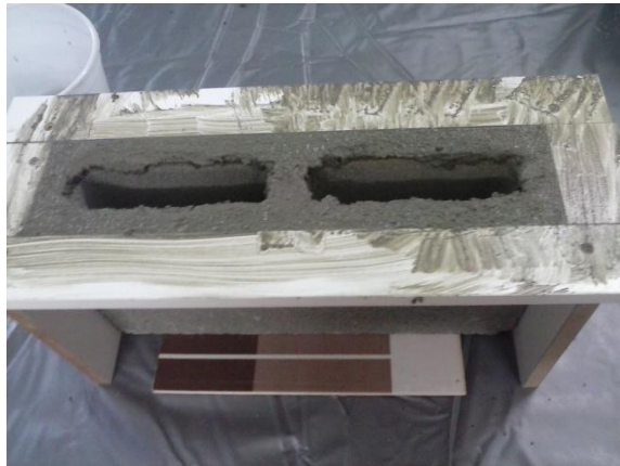
Figura 2: Capeamento do Bloco de Concreto
