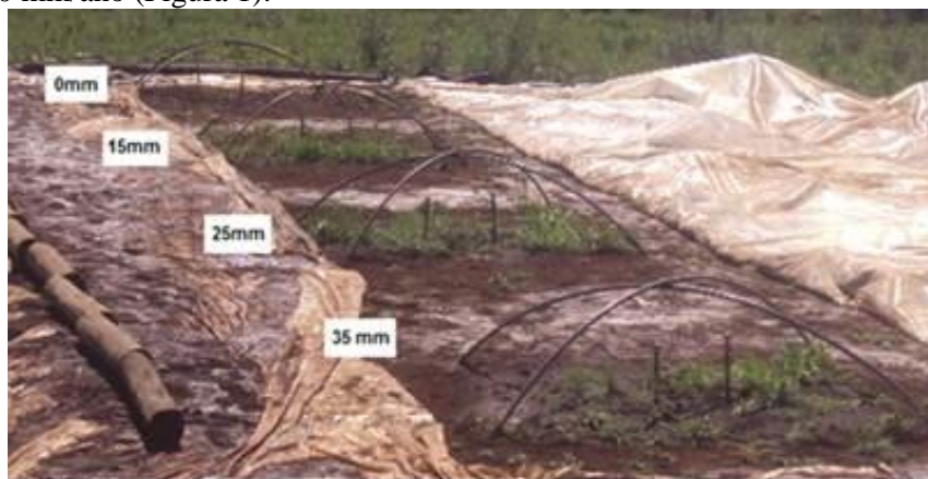
FIGURA 1. Detalhe de um dos blocos de parcelas, com o ordenamento das parcelas segundo o volume de água semanal, os tensiômetros instalados no centro de cada parcela e o tipo de solo e sua cobertura.
