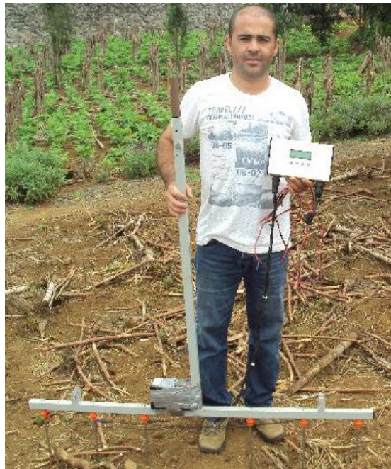
FIGURA 2. Condutivímetro de contato desenvolvido pela Embrapa Instrumentação com calibração de leitura fixa para as profundidades 0 a 20 cm e de 0 a 40 cm.
