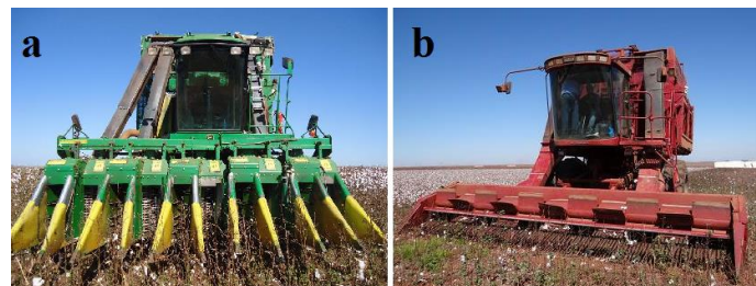
FIGURA 1.a) Colhedora com plataforma de colheita picker adaptada (kit cotton 45 Deltamaq) para colheita de algodão com espaçamento 0,45 m; b) Colhedora com plataforma de pente com sistema de colheita stripper . Fotos: Francielle Morelli Ferreira (2012).
