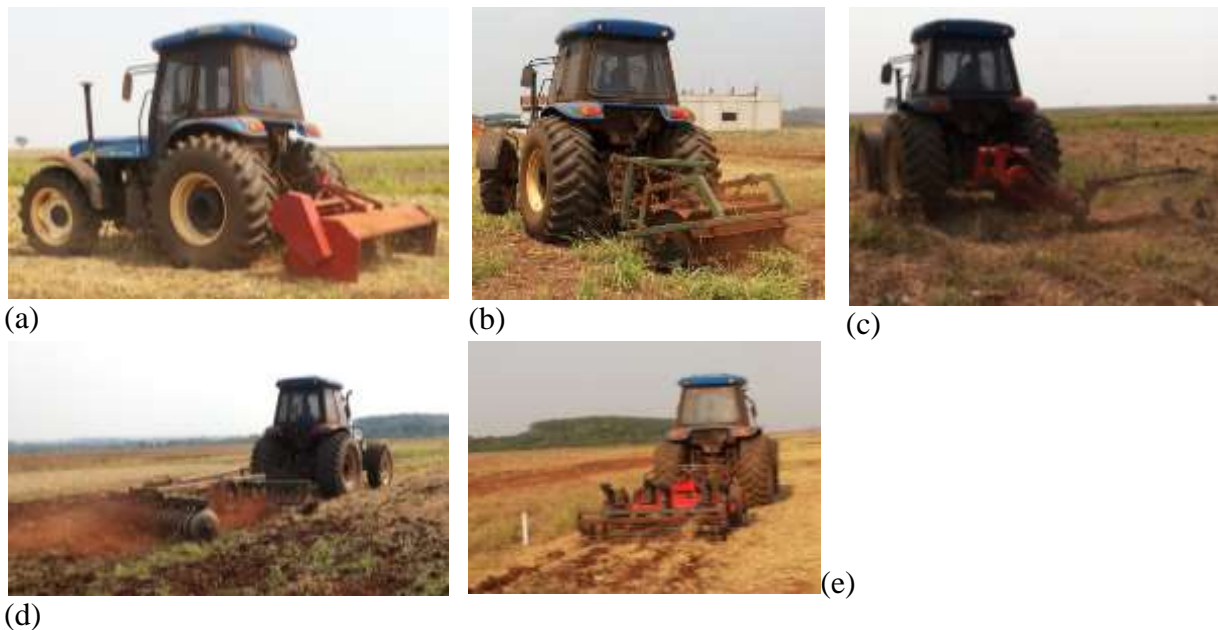
FIGURA 1. Sistemas de manejo da palhada e do solo. a – triturador de palhas; b – rolo-faca; c – segadora de forragem; d – grade destorroadora-niveladora; e –escarificador com disco de corte para palha e rolo destorroador.
