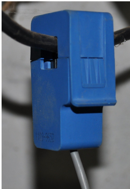
Figura 2. Sensor de corrente AC não intrusivo.
