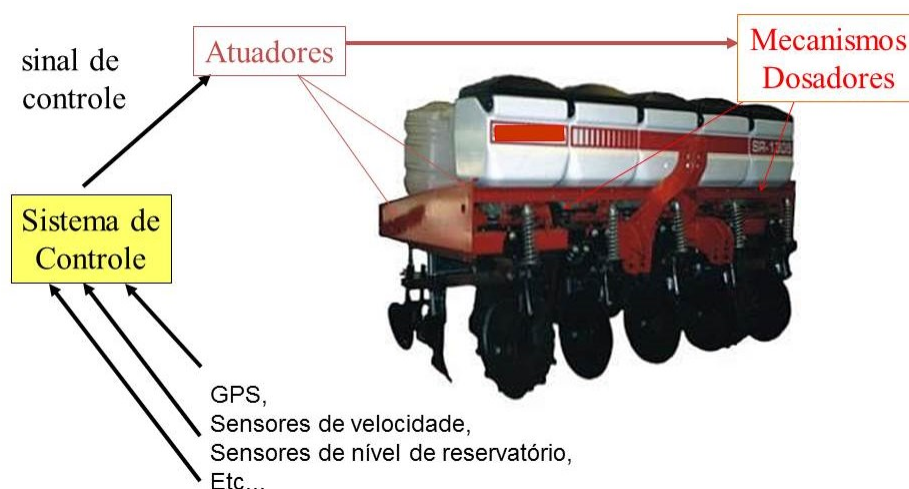
FIGURA 2. Esquema de sensoriamento e controle de uma semeadora-adubadora a taxa variável. (Fonte: Valdiero et. al., 2015)
