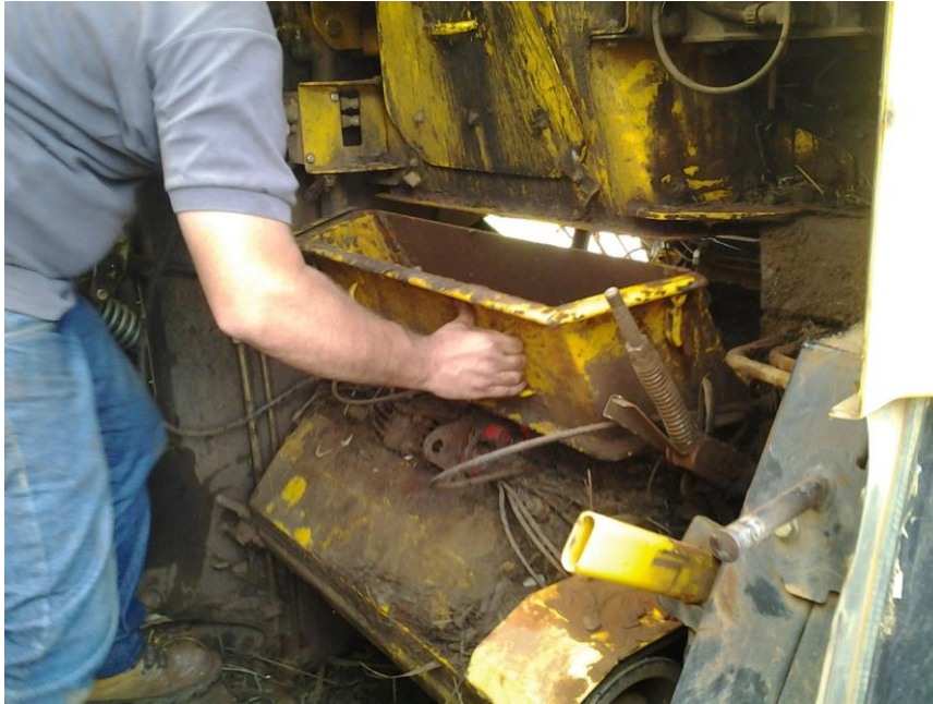
Figura 3. Acoplamento da peça no sistema da colhedora forrageira.
