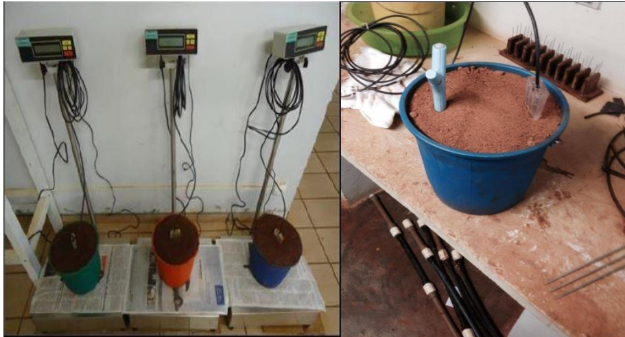
FIGURA 1. Pesagem dos baldes para mensurar a massa e obter a umidade através de método gravimétrico (à esquerda); instalação das sondas capacitivas wireless e das sondas TDR nos baldes (à direita).
