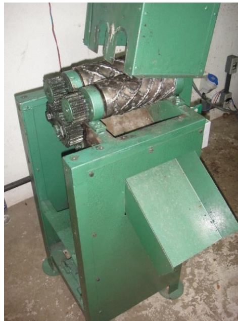
Figura 3: Quebrador comercial de endocarpos de frutos de macaúba. Fonte: Acervo pessoal.
