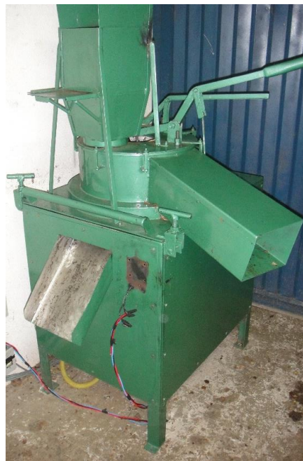
Figura 1: Despulpadora comercial de frutos de macaúba. Fonte: Acervo pessoal.
