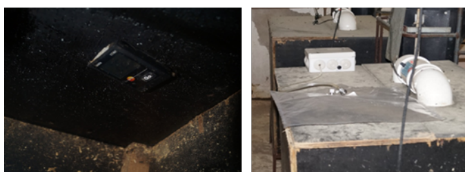
Figura 2 -“ Data-logger ”, Testo® fixado no interior do escamoteador e coleta de gases interno, em saco Tedlar.
