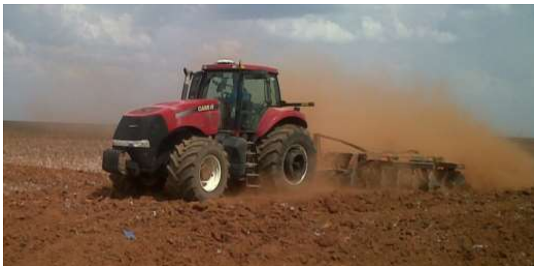
Figura 1. Trator Case Magnum 340 e grade pesada Civemasa em preparo do solo
