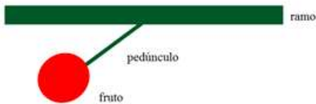
Figura 5. Representação esquemática do sistema utilizado para estimar a frequência natural do 1º modo de vibração do conjunto fruto-pedúnculo.
