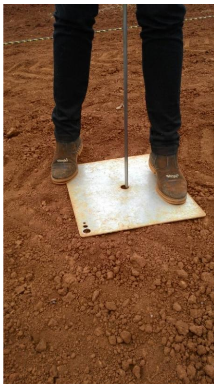
Figura2. Coleta de dados com penetrômetro
