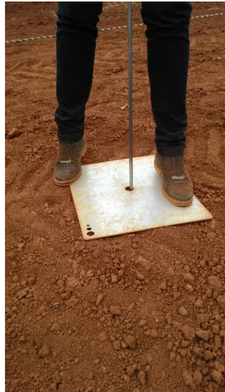
Figura2. Coleta de dados com penetrômetro
