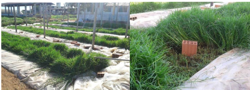
Figura 5 – Gramínea Paspalum vaginatum cultivada nos SACs com água residuária salina rica em nutrientes, no detalhe observa-se o tamanho dos colmos em relação a um tijolo.
