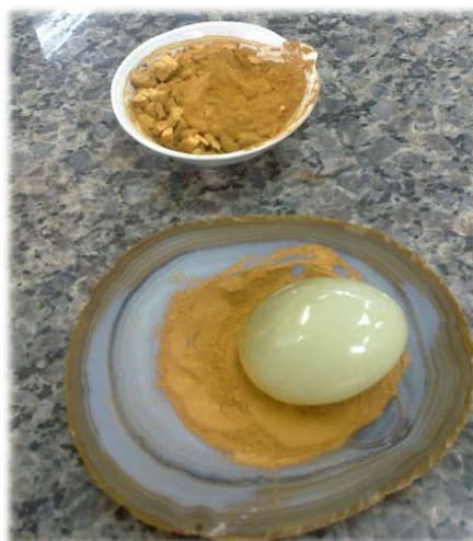
FIGURA 3. . Goethita em recipiente cerâmico seco em estufa e moída em graal de ágata
