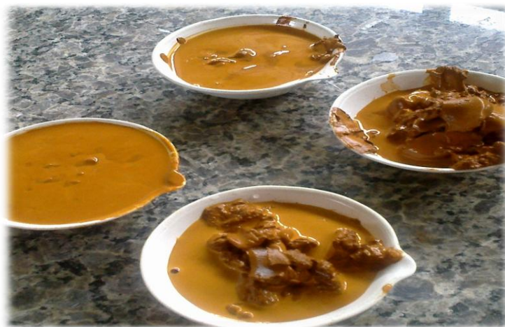
FIGURA 2. . Goethita em recipiente cerâmico pronto para secagem em estufa
